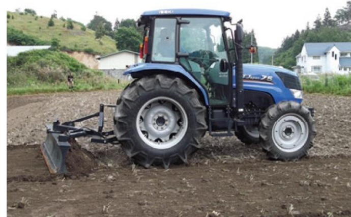
はぎ取り (表面の土を削り取る)
