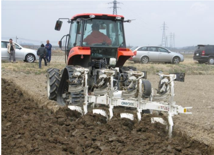
反転耕 (上下の土を入れ替える)
