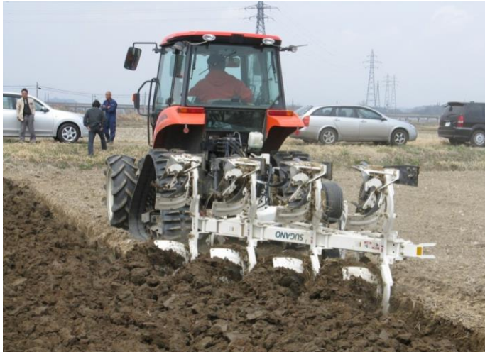
反転耕 (上下の土を入れ替える)
