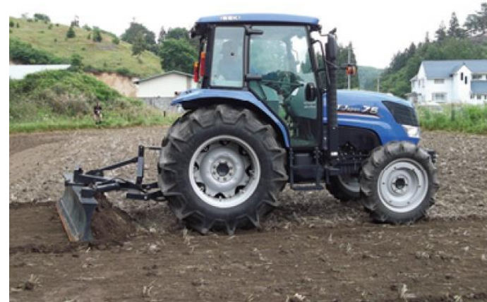
はぎ取り (表面の土を削り取る)
