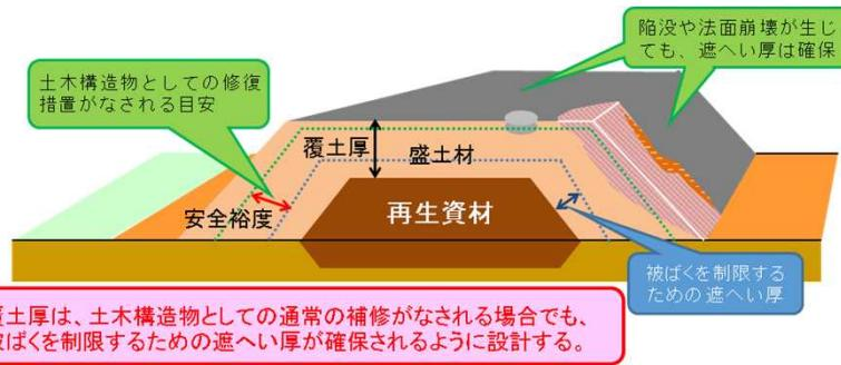
除去土壤を適切な前処理や分級などの物理処理をした後、用途先の条件に適合するよう品質調整等した**再生資材**(8,000Bq/kg以下を原則とし、用途ごとに設定)を、管理主体や責任体制が明確となっている公共事業等における人為的な形質変更が想定されない盛土材等の構造造基盤の部材に限定した上で、**適切な管理の下で限定期的に利用する。**
