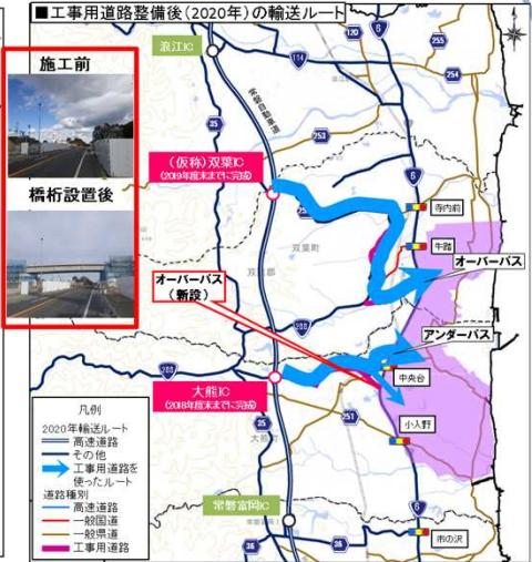
大熊ICからの工事用道路の施工例(国道6号橋梁新設工事)
