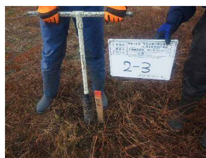
ハンドオーガーによる先行掘削状況
