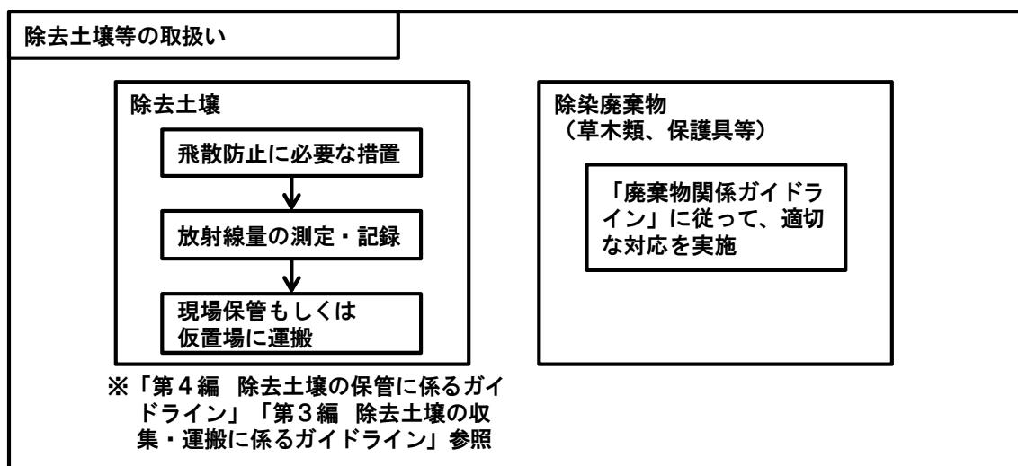
図2-28 除去土壤等の取扱いの基本的な流れ
