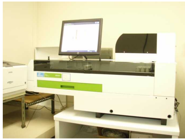
図3-4-2 NaI(Tl)シンチレーション スペクトロメータの例
