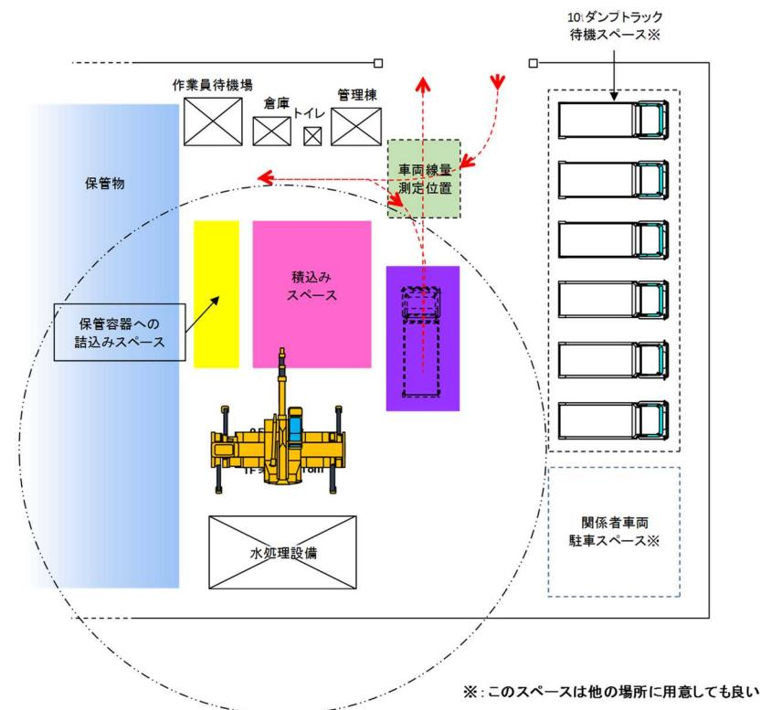
図 2.1.2-2 基幹輸送を行う積込場の図面例
