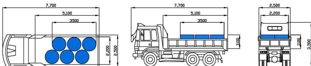
図 2.5.1-1 線源（積荷）の寸法
