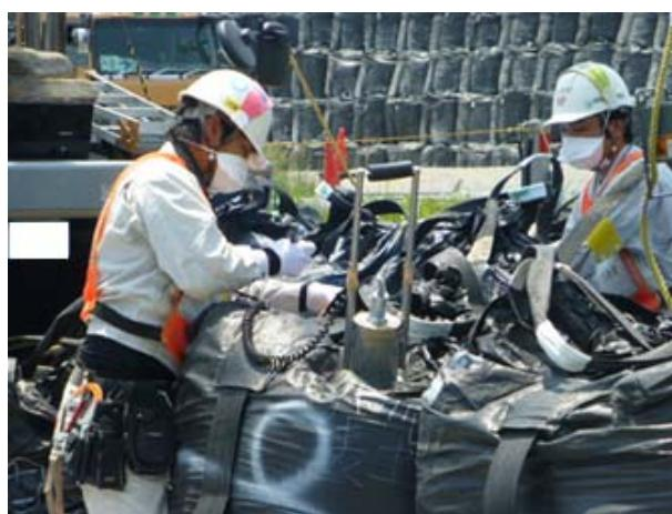
図 2.1.3-7 容器の表面線量率の測定状況
