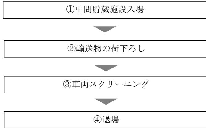
図 2.1.6-1 中間貯蔵施設における作業フロー
