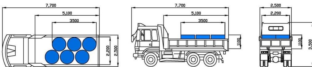
図 2.5.1-1 線源（積荷）の寸法
