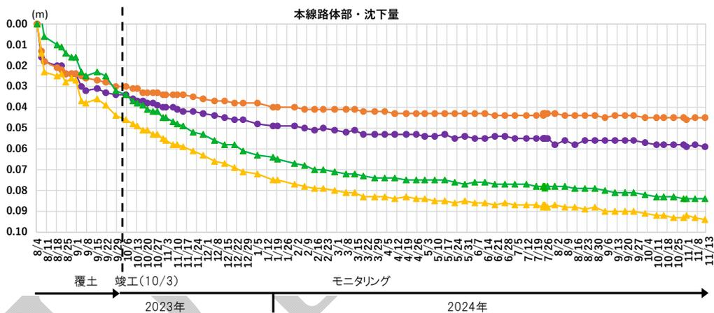
※車両走行による負荷を掛け、盛土の安定性及び使用性を確認するための走行試験を2024年7月23日（総重量約10t）、7月24日（総重量約20t）、10月29日（総重量約25t）に行った。
