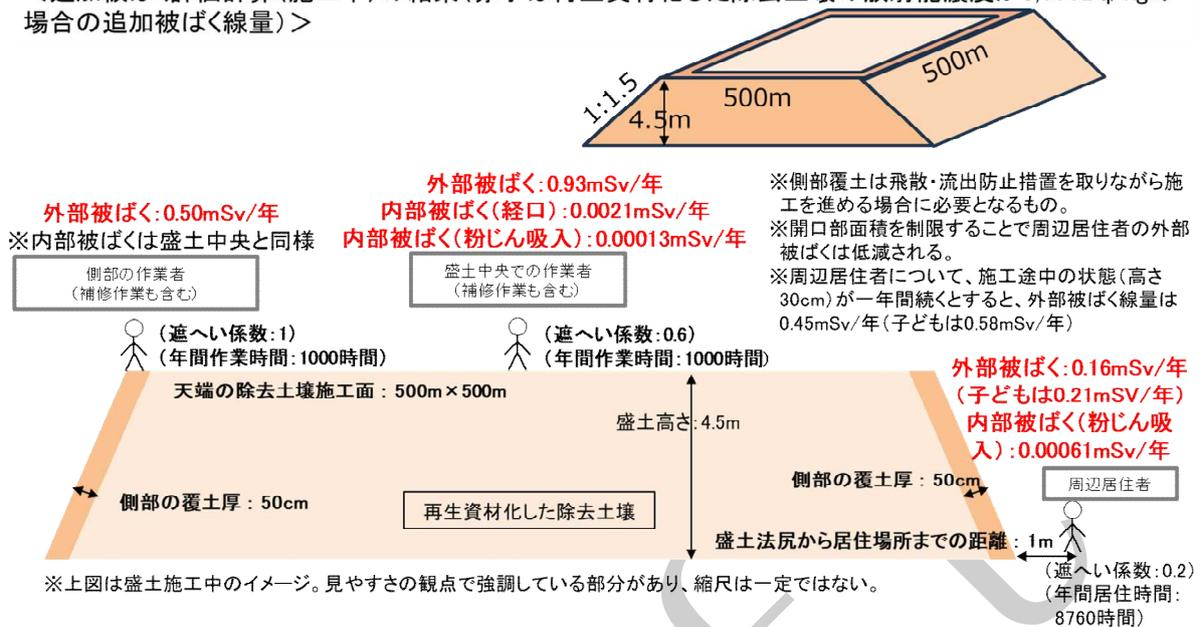
図 3-6 追加被ばく評価計算(施工中)の結果
