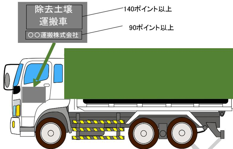
図3-3 運搬車の車体の外側の表示（例）
