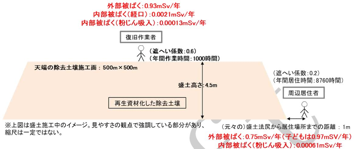
図 3-7 追加被ばく評価計算(災害時)の結果
