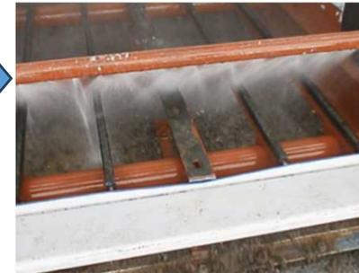
解泥後の土壌に水をかけながら、ふるいを振動させることで、主に「礫」を回収する設備
