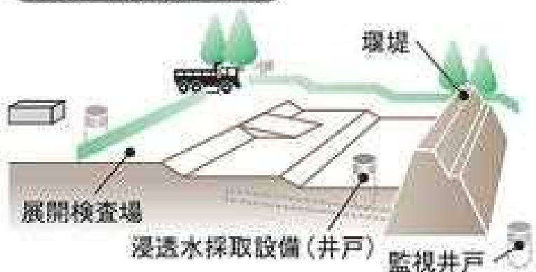
安定型最終処分場
