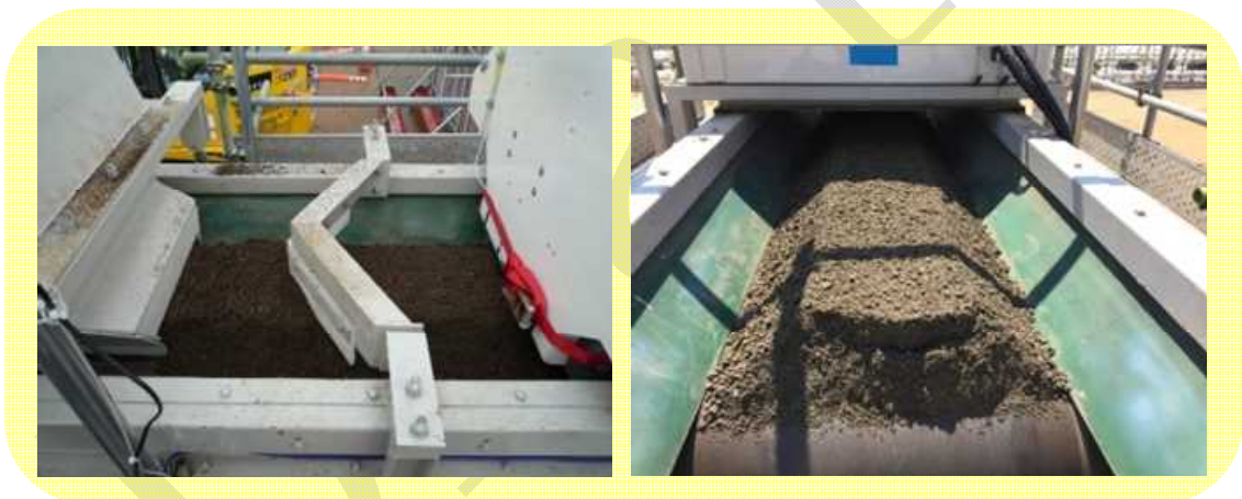
14 15 図 2-5 ベルトコンベヤによる放射能濃度測定装置 16 (南相馬市仮置場における試験盛土造成実証事業の例) 17
