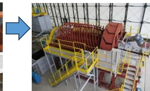
沈降分離により、砂と粘土・シルトを分別し、主に「砂」を回収する設備
