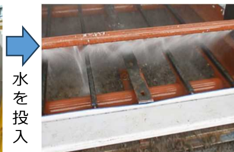
解泥後の土壌に水をかけながら、ふるいを振動させることで、主に「礫」を回収する設備
