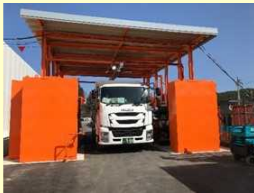
車載型放射能濃度測定装置(NaI(Tl) シンチレーションスペクトロメータ8個) による放射能濃度測定状況
