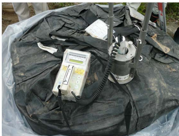
図 3-12 容器表面の放射線量率の測定状況
