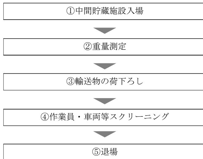
図 3-15 中間貯蔵施設における作業フロー
