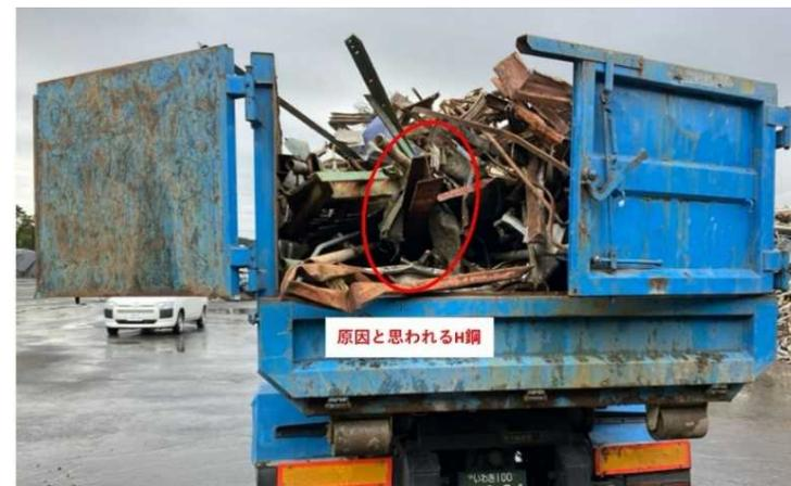
扉を強く押し付け開操作の障害になった長尺鋼材
