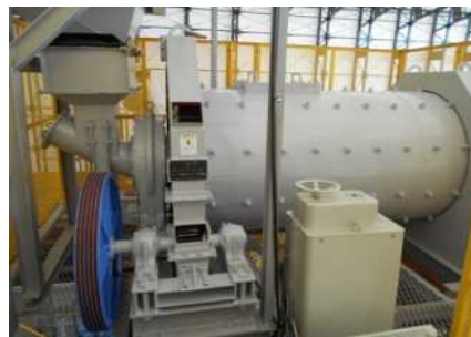
土壌をほぐすための解泥機
