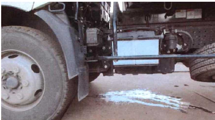
【エンジンオイル漏洩の状況】
