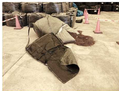
【内容物の飛散状況】
