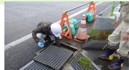
雨水排水の採取状況
