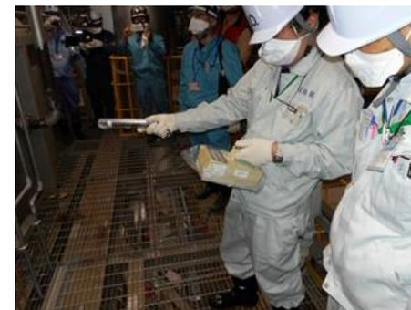
損傷箇所付近の空間線量率測定
