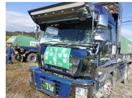
フロントガラス損傷
