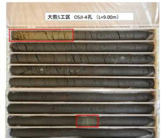
図2. ボーリング掘削で得られたコア(大熊⑤工区)
