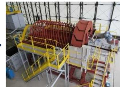
沈降分離により、砂と粘土・シルトを分別し、主に「砂」を回収する設備
