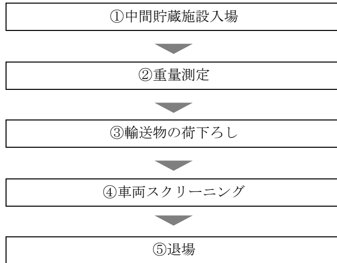
図 2.1.6-1 中間貯蔵施設における作業フロー
