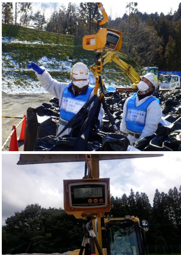
図 2.1.3-6 重量測定状況
