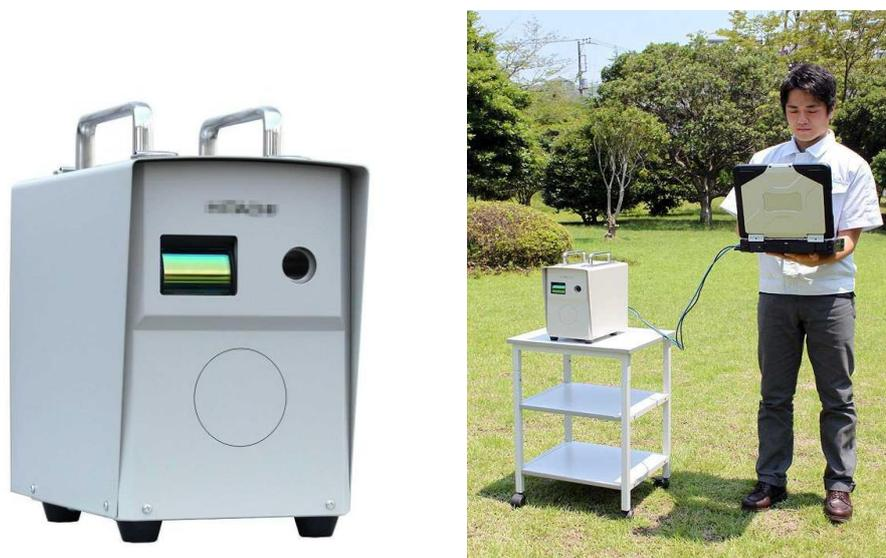
図 4-9 ガンマカメラの例
