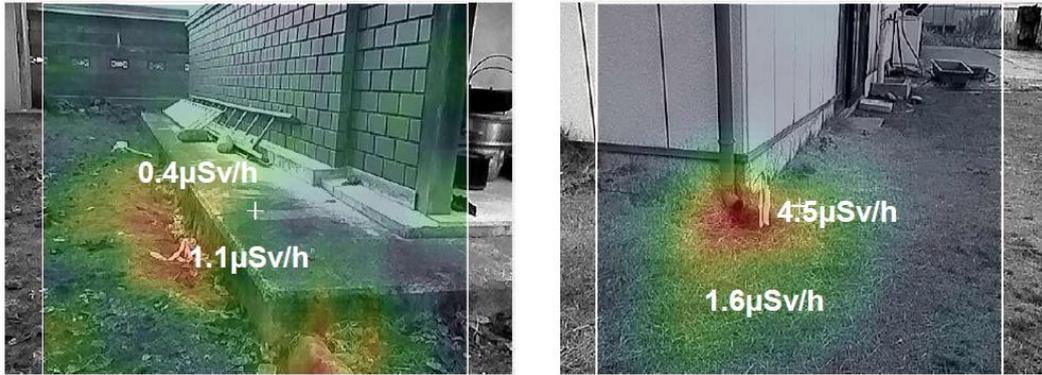
図 4-10 ガンマカメラの撮影例
