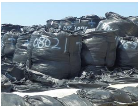
耐候性フレキシブルコンテナ (クロス型、1回利用)
