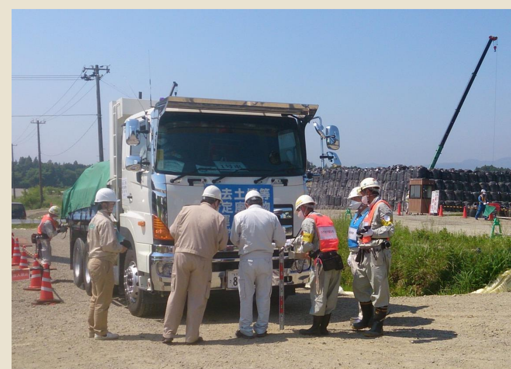
輸送前にトラック周辺の放射線量を測定し安全確認をしています。
