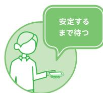
測定器が放射線に対して反応するのに必要な時間を「時定数」といいます。時定数の3倍を目安として、安定するまで待つことで、正確な測定結果が得られます。測定値がばらつくときは、複数回測定した結果の平均値を出してください。
