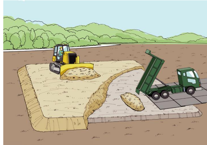
盛土・覆土による造成
