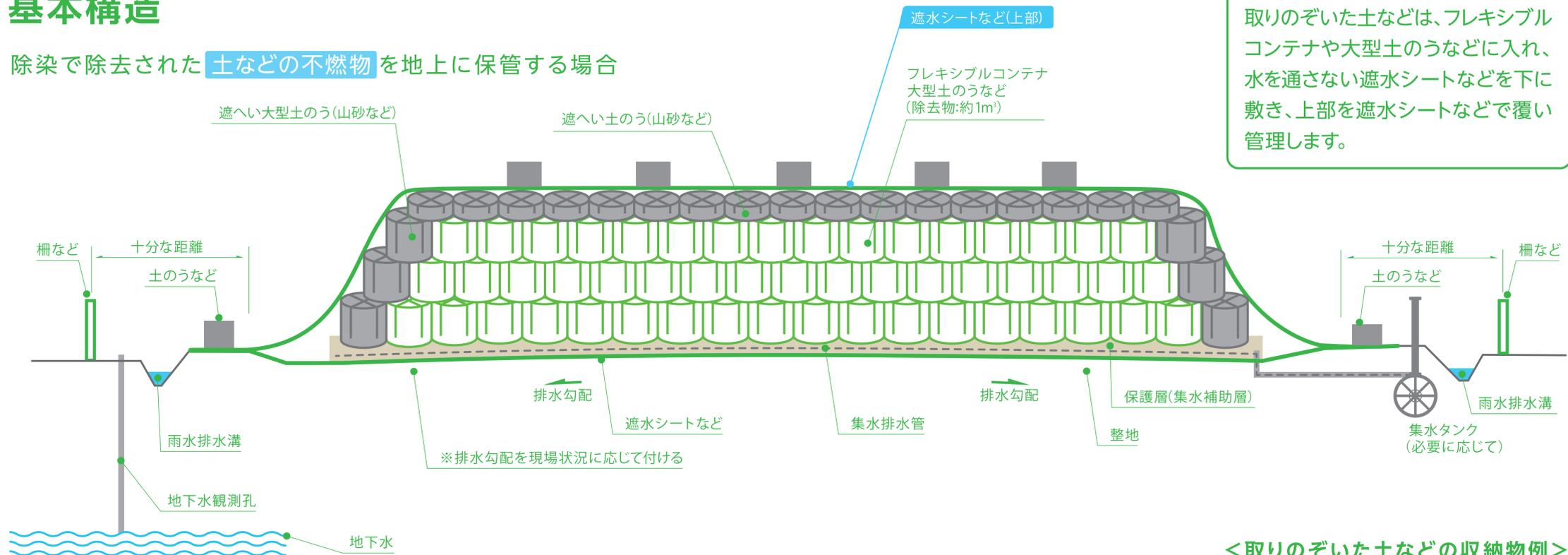
取りのぞいた土などは、フレキシブルコンテナや大型土のうなどに入れ、水を通さない遮水シートなどを下に敷き、上部を遮水シートなどで覆い管理します。
