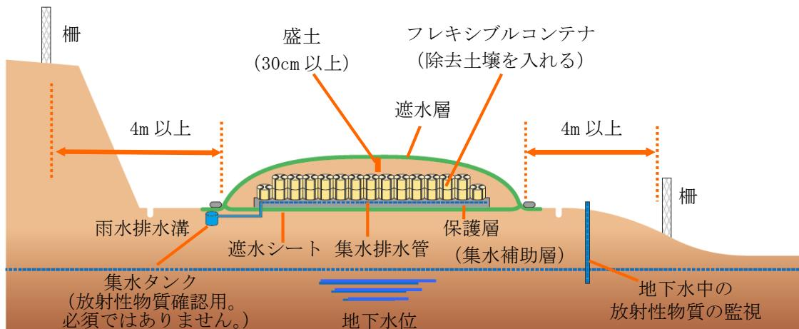
**図4-13 空間線量率が1マイクロシーベルト毎時程度の地域で発生した除去土壤(20×20×2m)の傾斜地における保管例**
