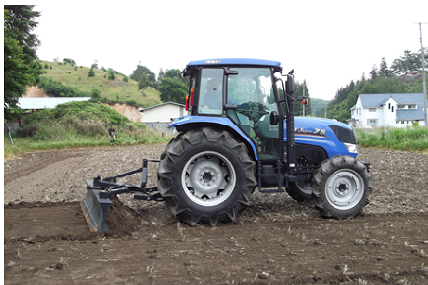
図 2-54 農機による農地の削り取りの例
