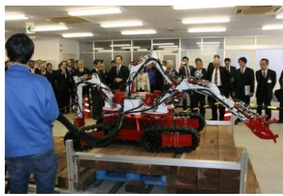
世界初「4本の腕を持つ」 災害対応ロボット“Octopus”
