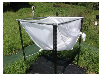
図1 リタートラップの設置状況
