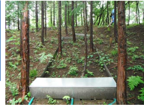
斜面試験枠(幅2m×奥行き5m)
