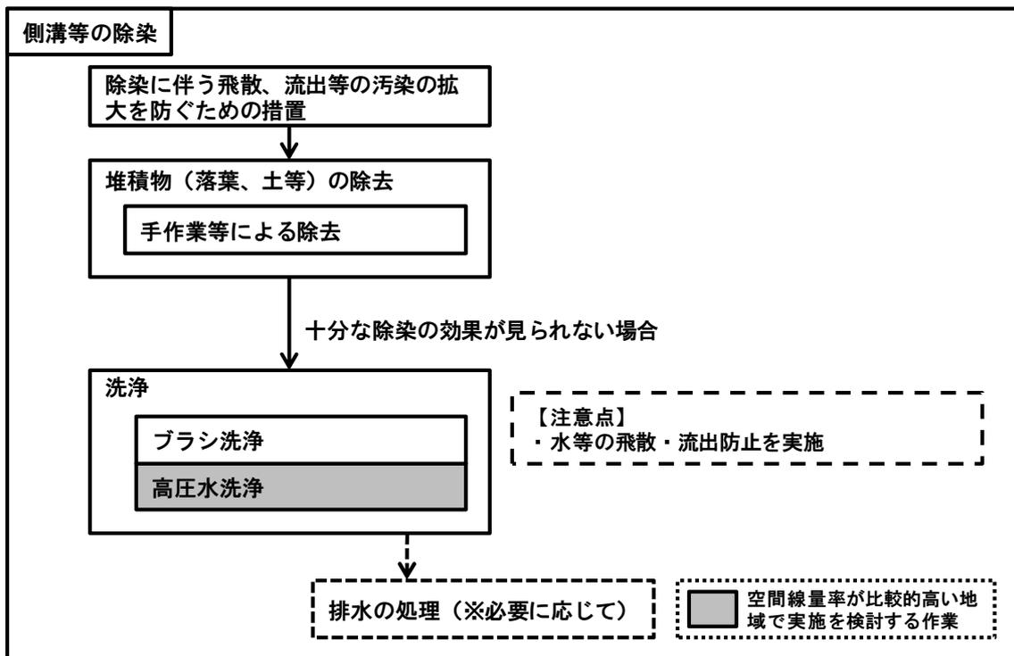
図 2-22 側溝等の除染の基本的な流れ
