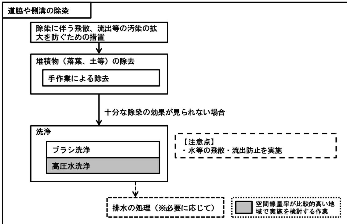
図 2-40 道脇や側溝の除染の基本的な流れ
