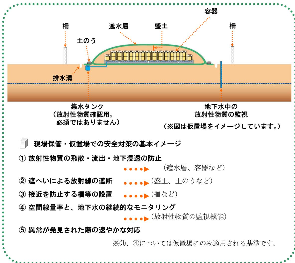
図4-1 現場保管・仮置場での安全対策の基本イメージ
