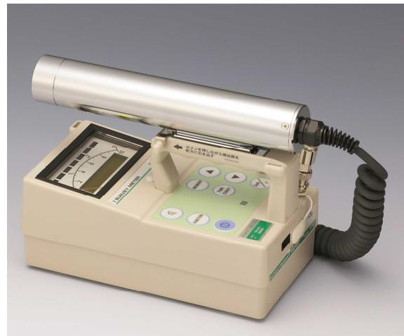
図1-7 シンチレーション式サーベイメータの例
