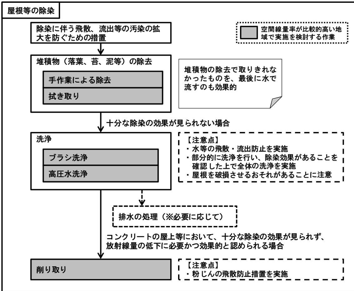
図 2-8 屋根等の除染の基本的な流れ
