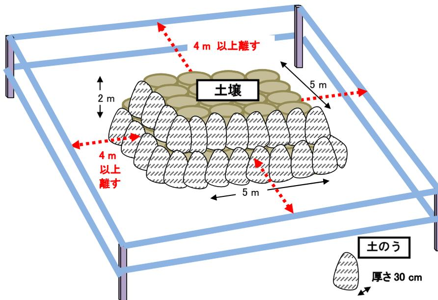
2万 Bq/kg の除去土壌（縦、横、高さが 5m×5m×2m）に対して側面を土のう（30cm）で遮へいした場合
