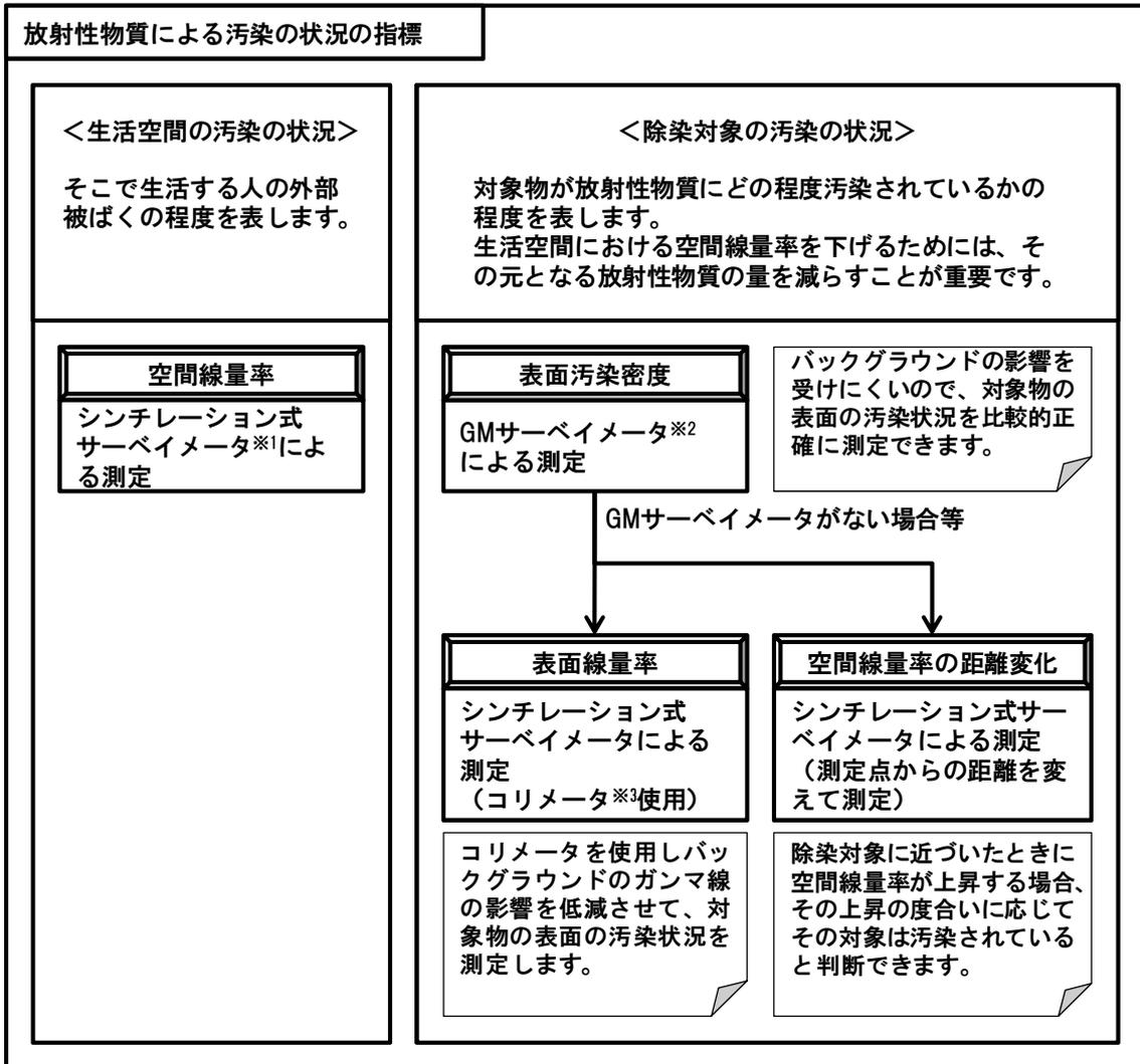
※1：NaIシンチレーションサーベイメータ、CsIシンチレーションサーベイメータ 等
