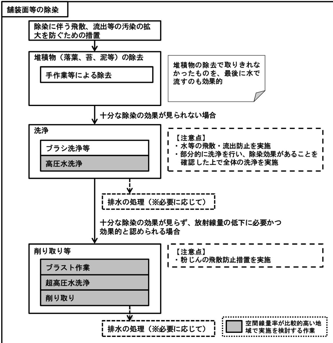
図 2-36 舗装面等の除染の基本的な流れ
