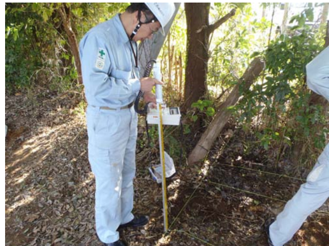
図8(2) 空間線量率の測定(地表 1m)
