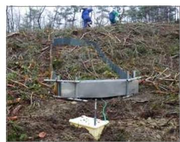
設置した試験斜面枠
