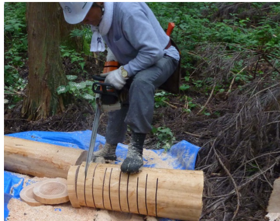
写真5 材の試料のサンプリング
