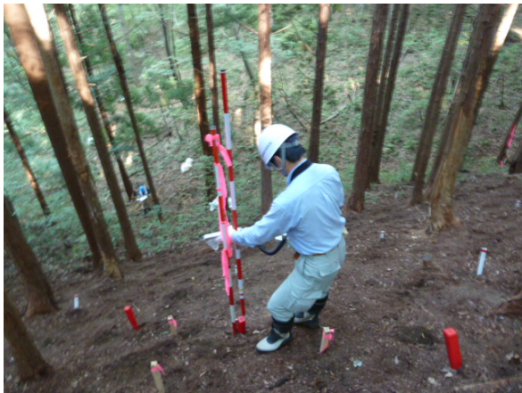
写真5 除去後の空間線量率の測定
