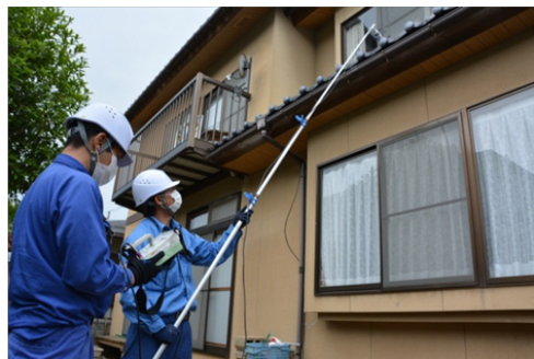
①-3 高所測定機器によるモニタリング
