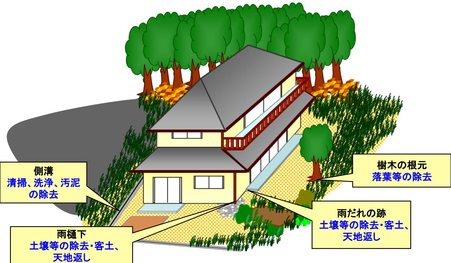
※対象箇所がコンクリート等である場合はブラシ洗浄、高圧洗浄及び超高圧洗浄のいずれかを実施
