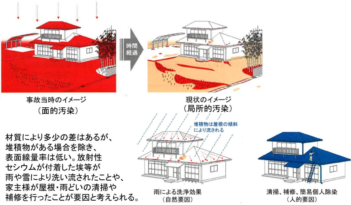
材質により多少の差はあるが、堆積物がある場合を除き、表面線量率は低い。放射性セシウムが付着した埃等が雨や雪により洗い流されたことや、家主様が屋根・雨どいの清掃や補修を行ったことが要因と考えられる。
