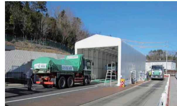
放射線検査を行い廃棄物を搬入する様子
