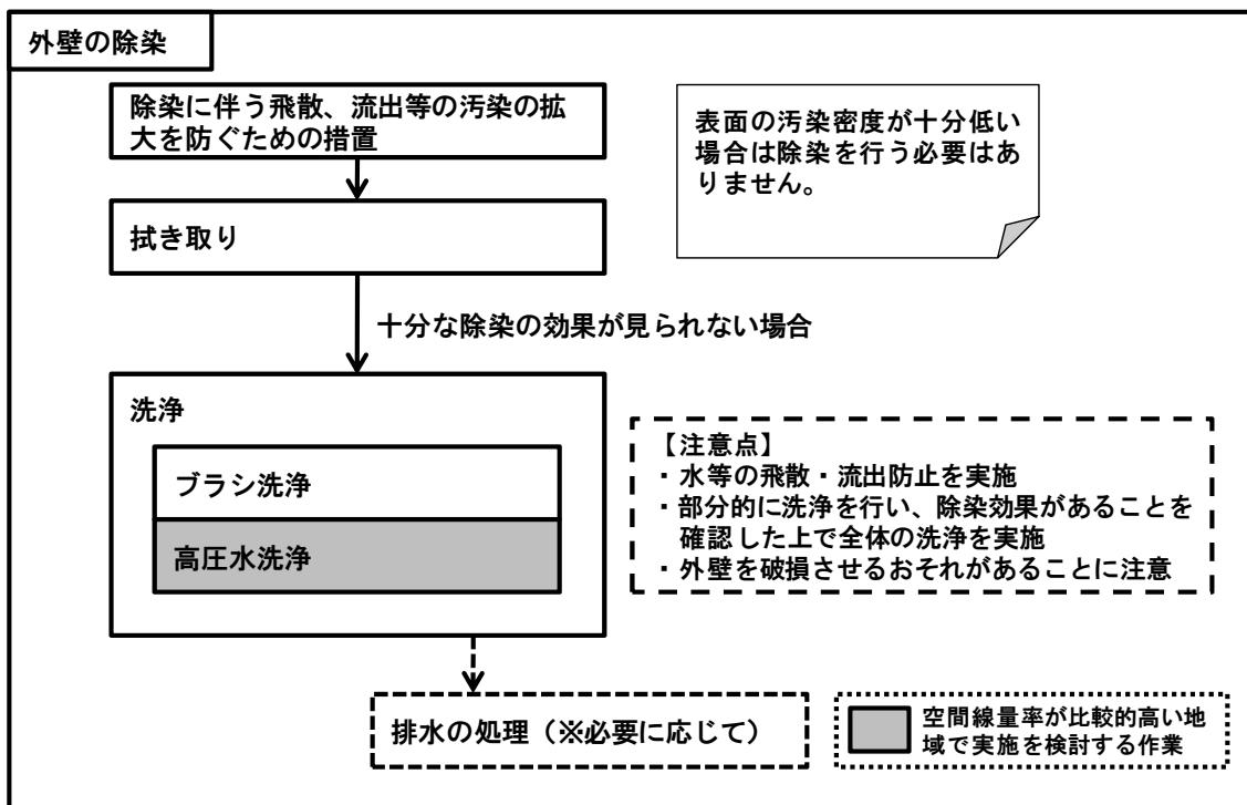
図 2-14 外壁の除染の基本的な流れ
