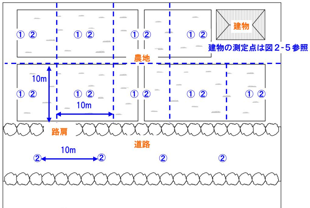
図 2-46 土壤の除染等の措置（農地）における測定点の記録略図の例
