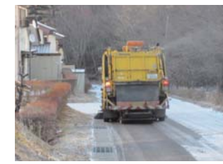
道路 路面清掃車で路面堆積物除去
