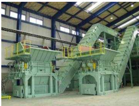
図 4-3 破碎機の屋内設置（例）
