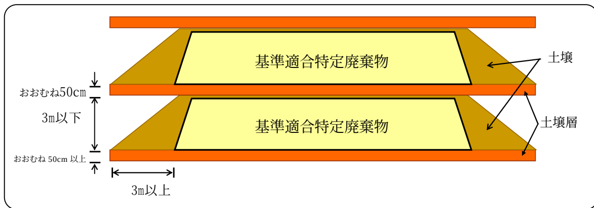
図 5-17 土壌層と層状埋立のイメージ図
