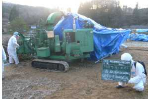
図 2-26 破碎機（チップパー）による減容化（例）
