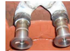
マイクロバブル 渦崩壊洗浄装置
