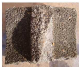
コンクリート ( 左 : 洗浄前、右 : 洗浄後 )
