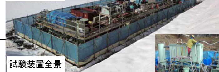
マイクロバブル 渦崩壊洗浄装置
