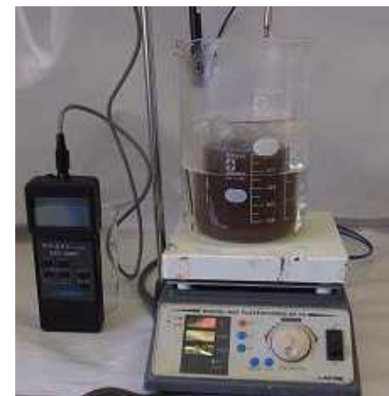
セシウム溶離試験の状況
