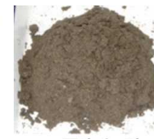
再生土-砂 ( \phi 300~75 \mu m 以上)
