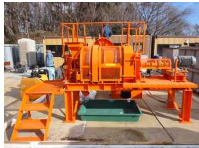
摩砕洗浄機 (洗浄部分: 60cm × 100cm)
