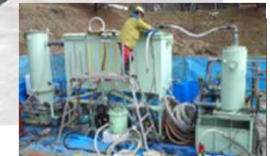
浮上分離濁水処理装置
