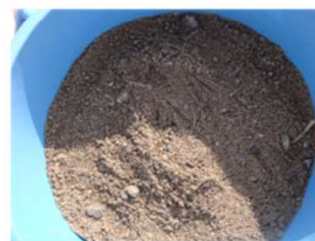
土砂 ( 左 : 洗浄前、右 : 洗浄後 ) ( 摩砕洗浄 )
