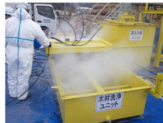
木材洗浄ユニット (高圧水洗浄)
