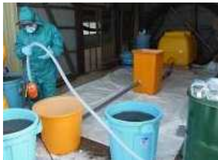
模擬水路による吸着 効果確認試験
