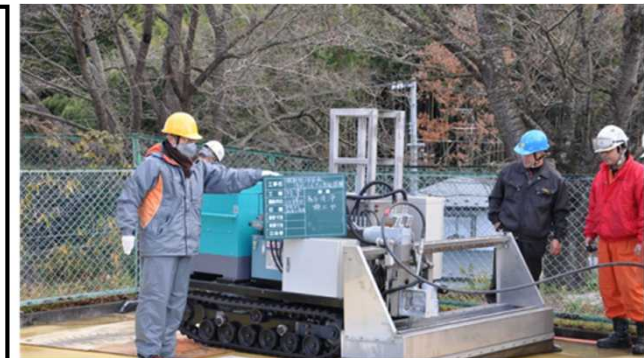
自走式高圧洗浄機による除染
