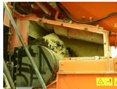
改質機の土砂詰りの状況
