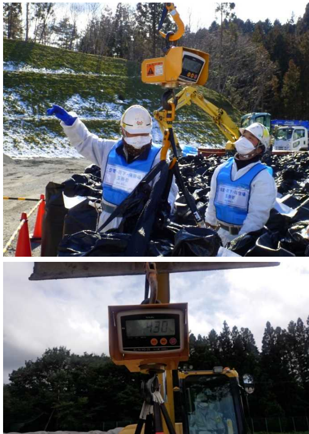
図 2.1.3-7 重量測定状況
