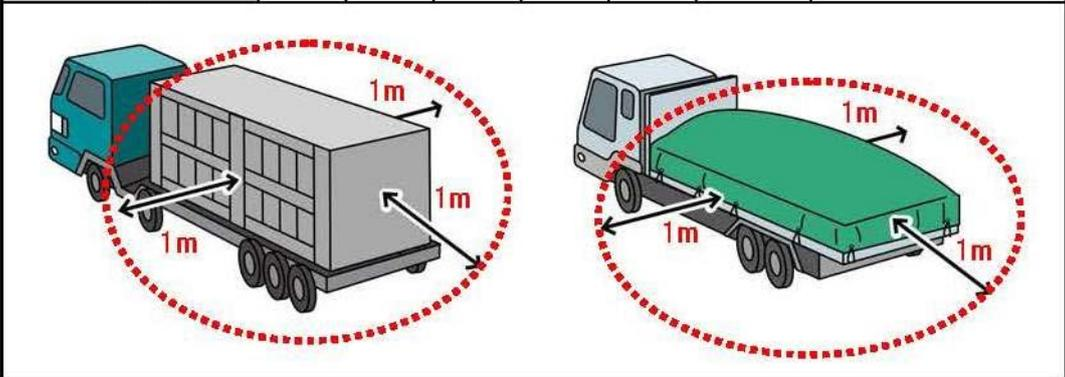
図 2.1.3-10 輸送車両から  $1\text{m}$  の地点における空間線量率の試算例
