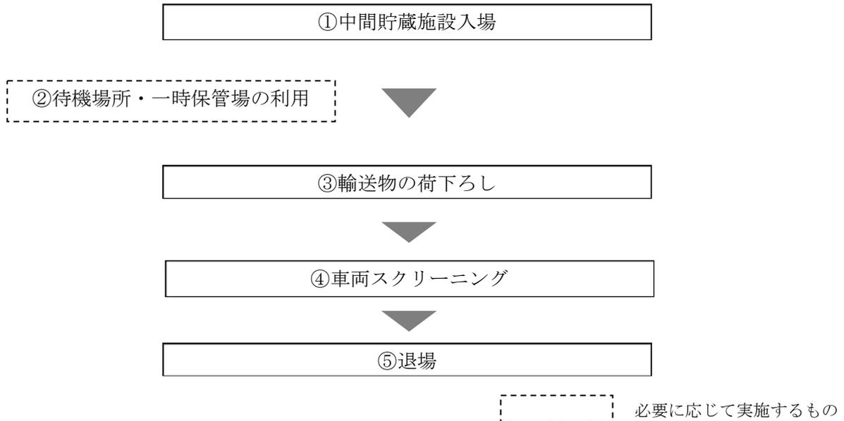
図 2.1.6-1 中間貯蔵施設における作業フロー
