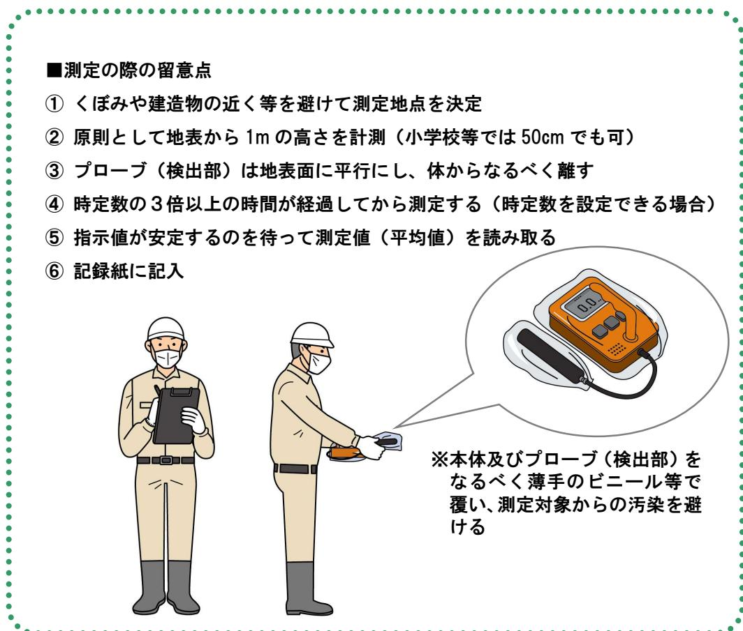
図 1-10 測定機器の使用方法（シンチレーション式サーベイメータ）
