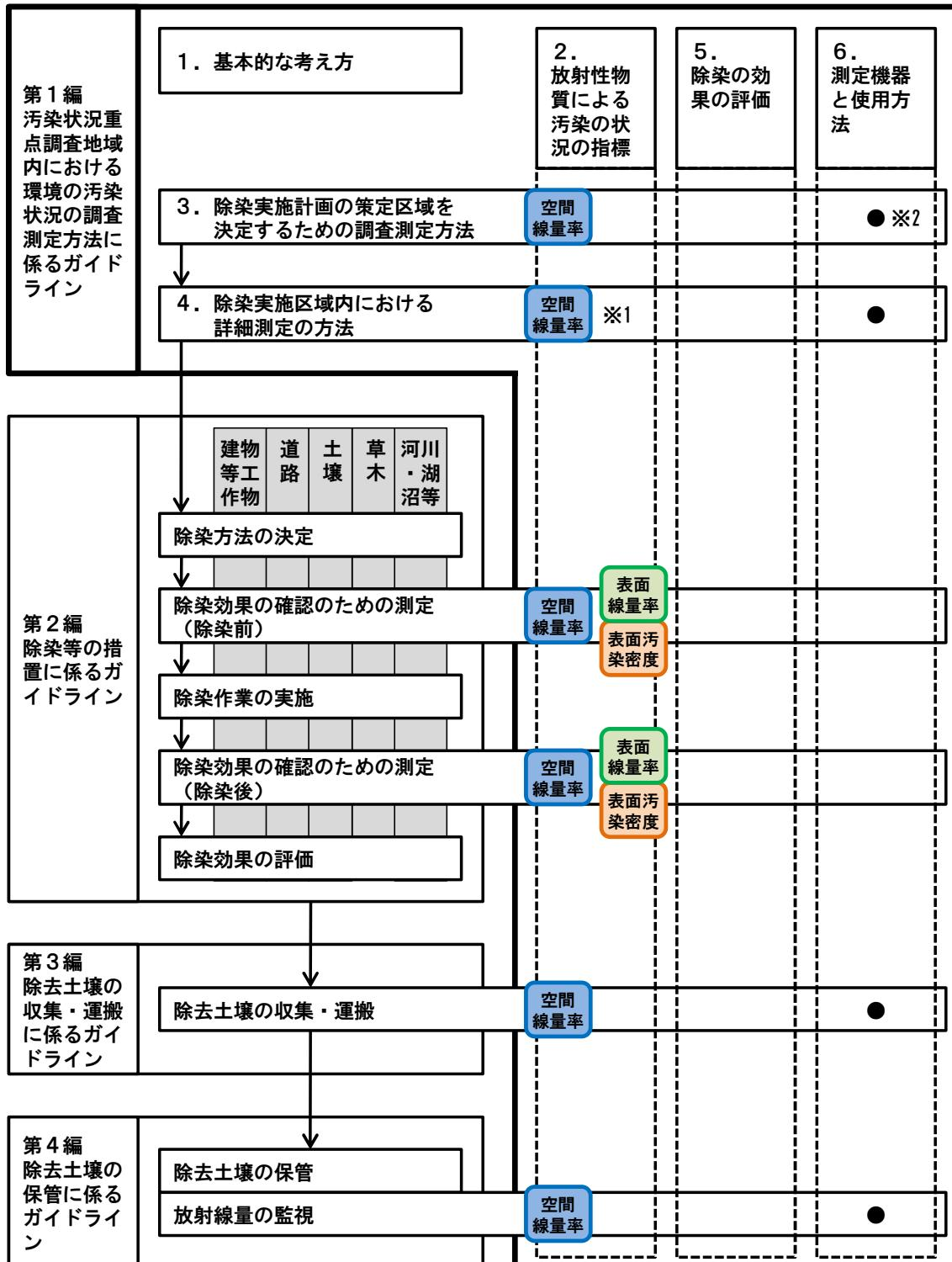
※1：「4. 除染実施区域内における詳細測定」が「除染効果の確認のための測定（除染前）」を兼ねる場合は、表面線量率または表面汚染密度の測定も実施します。
