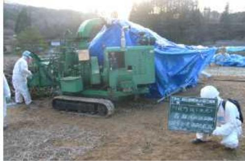
図 2-26 破砕機（チップパー）による減容化（例）
