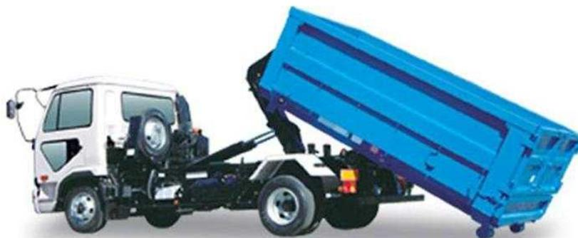
図 3-5 脱着装置付コンテナ専用車（例）
