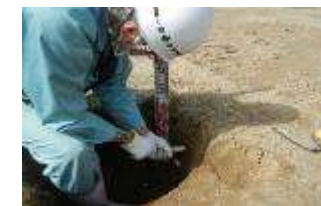
山中式硬度計による硬度確認
