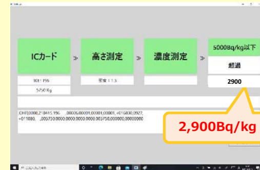
バルクスキャンによる 放射能濃度測定状況（下段：出カイメージ）
