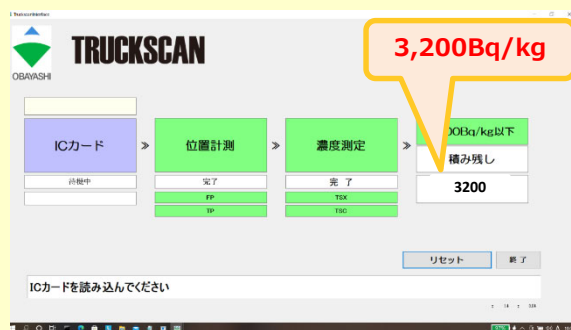
トラックスキャンによる 放射能濃度測定状況（下段：出カイメージ）
