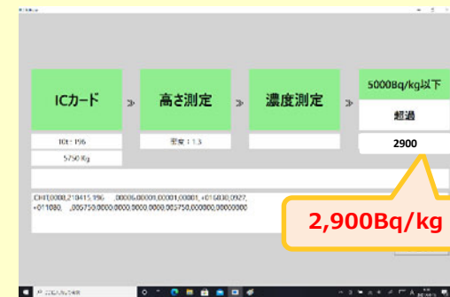
バルクスキャンによる 放射能濃度測定状況（下段：出カイメージ）
